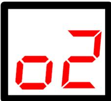
Mit dieser Option kann man die Hysterese der Pumpe einstellen. Wenn der Unterschied zwischen der Temperatur der Einstieg in Betriebszyklus (Einschaltschwelle) und der Temperatur der Rückkehr in den Stillstand (Beispiel: *die vorgegebene* Temperatur hat einen Wert von 60°C und Hysterese beträgt 3°C, Übergang zu dem Betriebszyklus erfolgt nach dem Erreichen der einer Temperatur von 60C und der Rückkehr in den Stillstand erfolgt nach der
